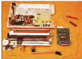
La Cinetec 120-D aperta e smontata in tutte le sue parti a destra la scheda di interfaccia
