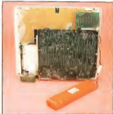
Una vista aperta di Z-181 mostra il pacco di batterie ricaricabili e la scheda aggiuntiva di memoria. In alto a destra il retro della macchina con i connettori di quadri; in basso un particolare della tastiera di controllo da driver.
