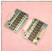
La matrice base di componenti e la completa scheda di espansione RAM da mezzo Megalox in evidenza nelle due parti
