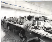
Una fase del collaudo delle schede prima del montaggio dei computer. Sotto, una fase della realizzazione del master.
