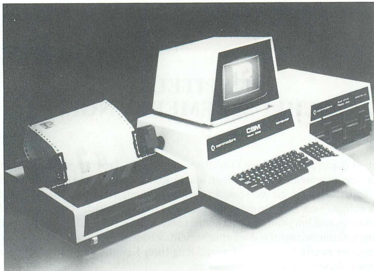
Bild 11-1: Der PET: Ein typischer Heimcomputer mit allen Bestandteilen in einem Gehäuse
